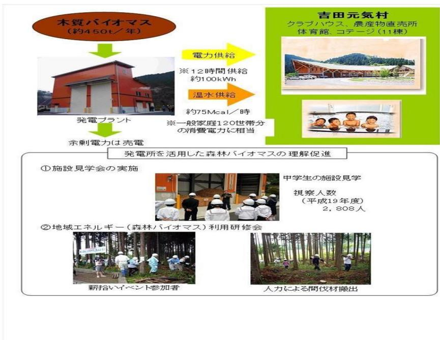
図 26.バイオマス発電所概要
