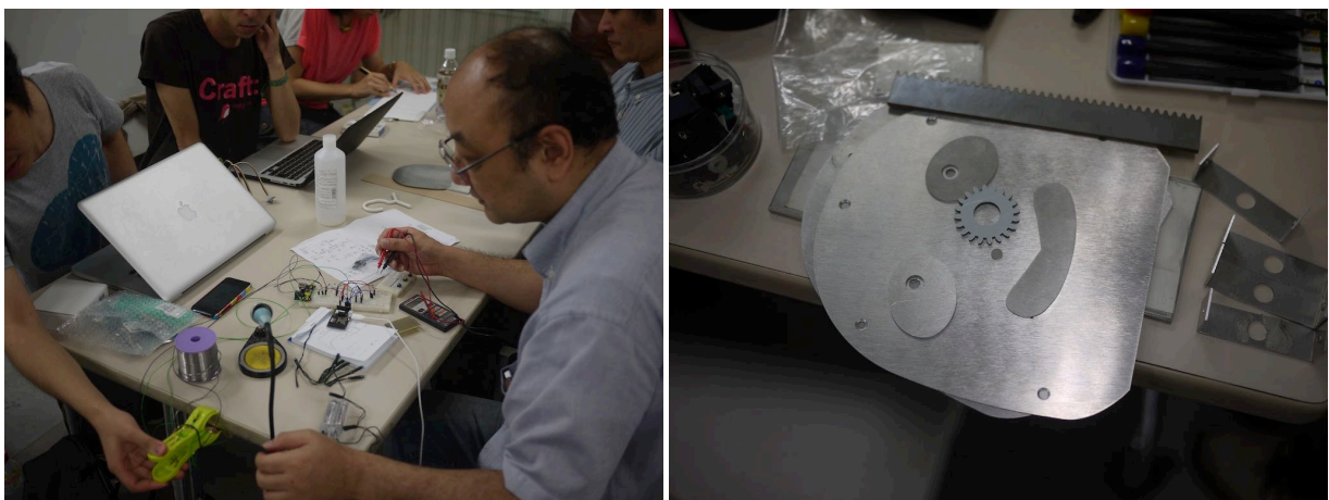
(a) 持ち寄った電子部品やアプリケーションを統合している様子 (b) 高出力のレーザー加工機でアルミニウム版を切断して製作した筐体
