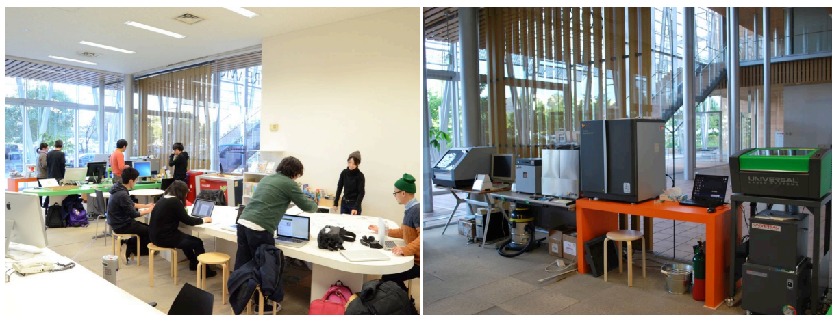
(a) 2012 年当時の f.Labo の内部全体の様子。中央部 (b) f.Labo に設置したデジタル工作機械。左から 3D 分に 2つの大きなテーブルがあり、壁面はスケッチな切削加工機 (ローランド ディー. ジー. の MDX-40A) どを配置できるように大きく空けて工作機械等を配置 と 3D プリンタ (Ember Surge の V-Flash)、レーザー加工機 (Universal Laser Systems の VLS2.30)。
