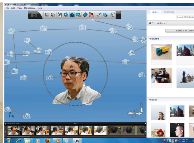
(b) 撮影した静止画を 123D Catch で 3D モデルに変換した様子
