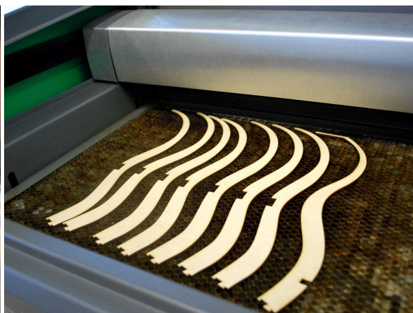
(b) レーザー加工機で MDF を加工している様子
