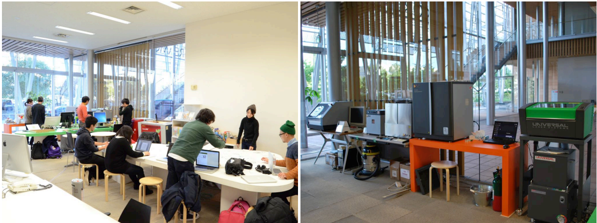
(a) 2012 年当時の f.Labo の内部全体の様子。中央部 (b) f.Labo に設置したデジタル工作機械。左から 3D 分に 2 つの大きなテーブルがあり、壁面はスケッチな切削加工機（ローランド ディー. ジー. の MDX-40A）を配置できるように大きく空けて工作機械等を配置と 3D プリンタ（Ember Surge の V-Flash）、レーザー加工機（Universal Laser Systems の VLS2.30）。
