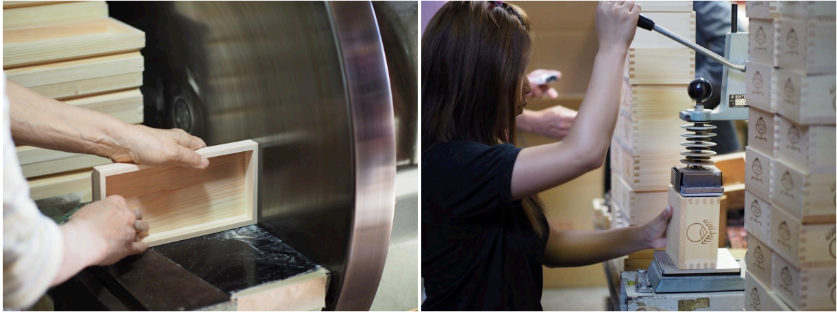
(a) 高速で回転する円盤状の機械「円盤カンナ」を用いる仕上げ削りの工程の様子。 (b) 専用の焼印機にデザインされた銅版を設置して杓に高温で圧力をかけて焼き付けていく焼印の工程の様子。
