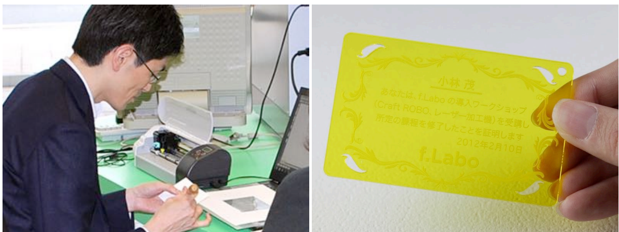
(a) 導入ワークショップの様子。PC上でIllustrator (b) 導入ワークショップの成果物。レーザー加工機で を用いてレーザー加工機で加工するためのデータをテ 切断と彫刻を行って受講証をつくることにより、スキ ンプレートを元に自分の名前等に変更を加えてつくる。ルを習得すると同時に導入ワークショップの履修証明 になるようにした。
