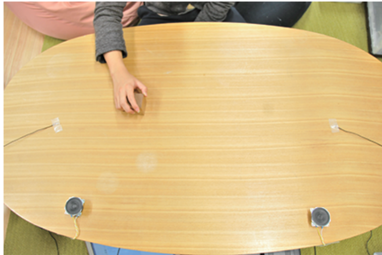
図 4.11: マイクの設置位置の真下にスピーカーを設置した
