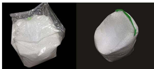
図 3.18: 発泡ポリスチレンビーズによる Chair のフィジカルスケッチ（吸引前と吸引後）
