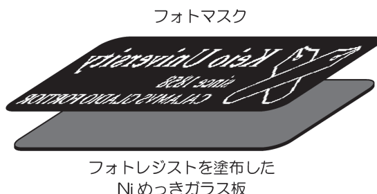
図10. フォトマスクの乗せ方。原稿を裏返しにしなければならない点に注意する。また、光を通さない黒い部分が鏡として残る。
