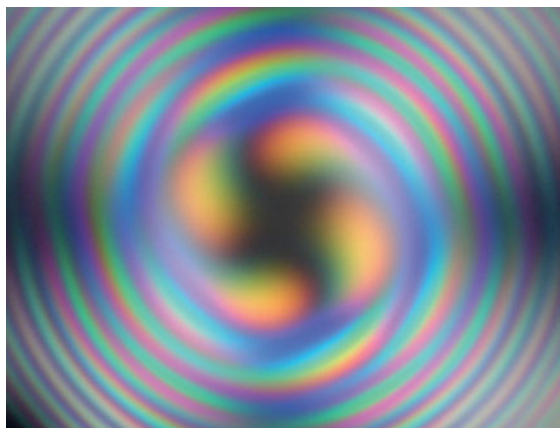
図10. 右水晶板の上に左水晶板を重ねたときのコノスコープ像 (水晶板の厚さは各 4 mm, 偏光板は垂直配置)
