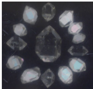
図12. 水平面内での水晶の光軸の方位と通過光との関係(偏光板は垂直配置)
