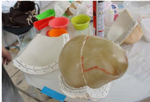
図 5.9: 3 パーツ分割の複製型と素体
