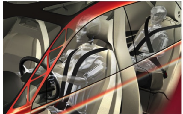
図 2.7: Volvo 社 ピラー素材の透明化による車両周辺環境視認性向上の提案 [5]
