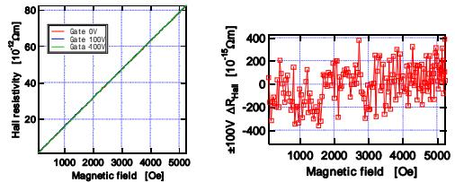
図 11 . Pd薄膜のホール電圧の磁場依存性。
